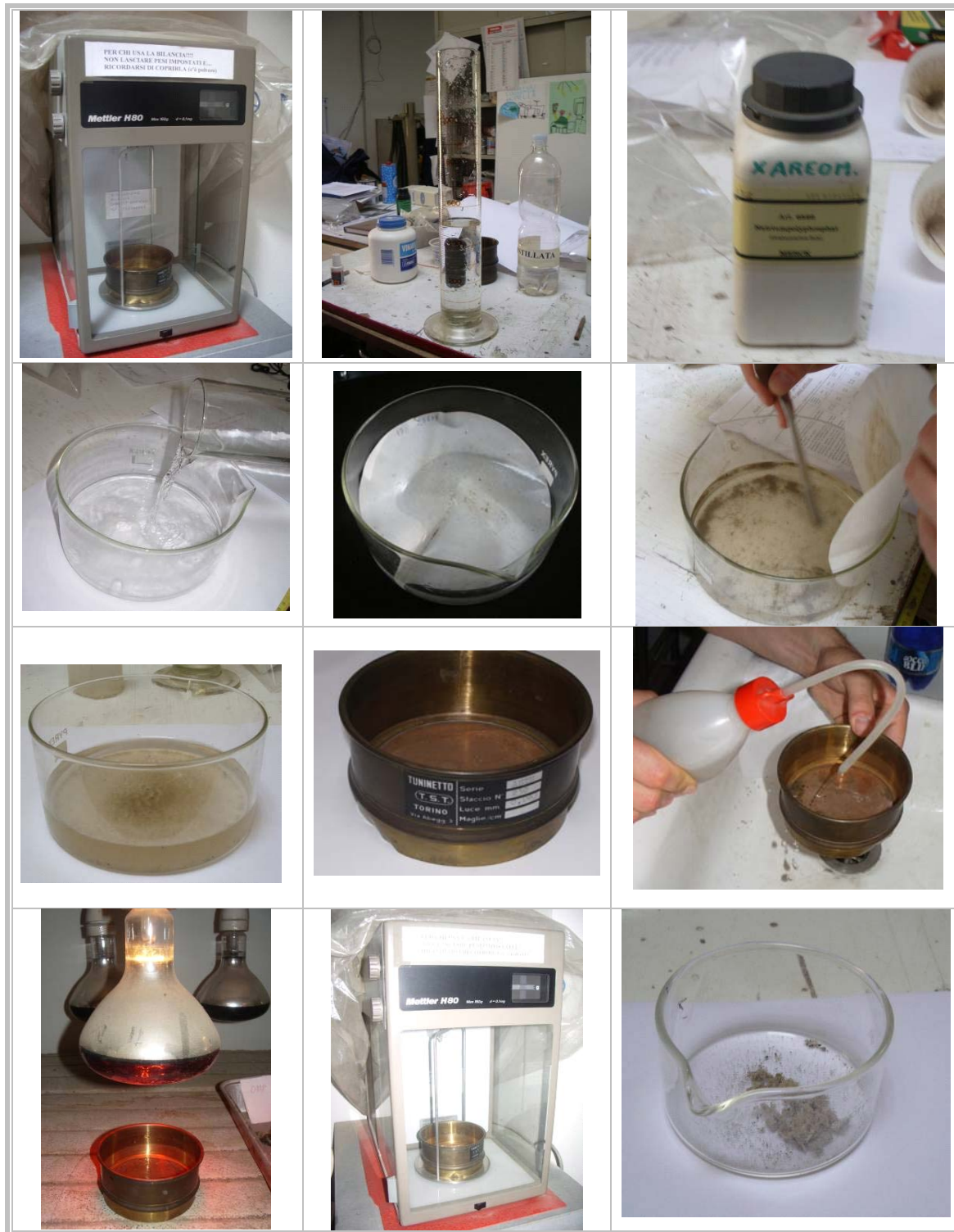
Figura 2-2 - Fasi di lavoro durante l'analisi dei filtri ottenuti da misure di trasporto solido in sospensione.
