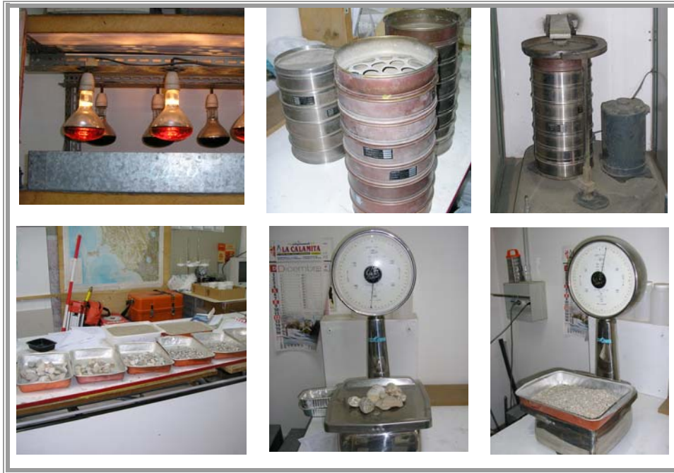
Figura 2-4 - Fasi di lavoro durante setacciatura a secco
