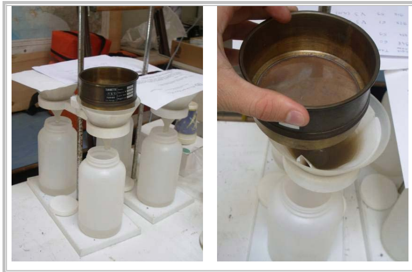
Figura 2-3 - Fasi della procedura di lavoro durante l'analisi dei campioni di trasporto solido in sospensione.
