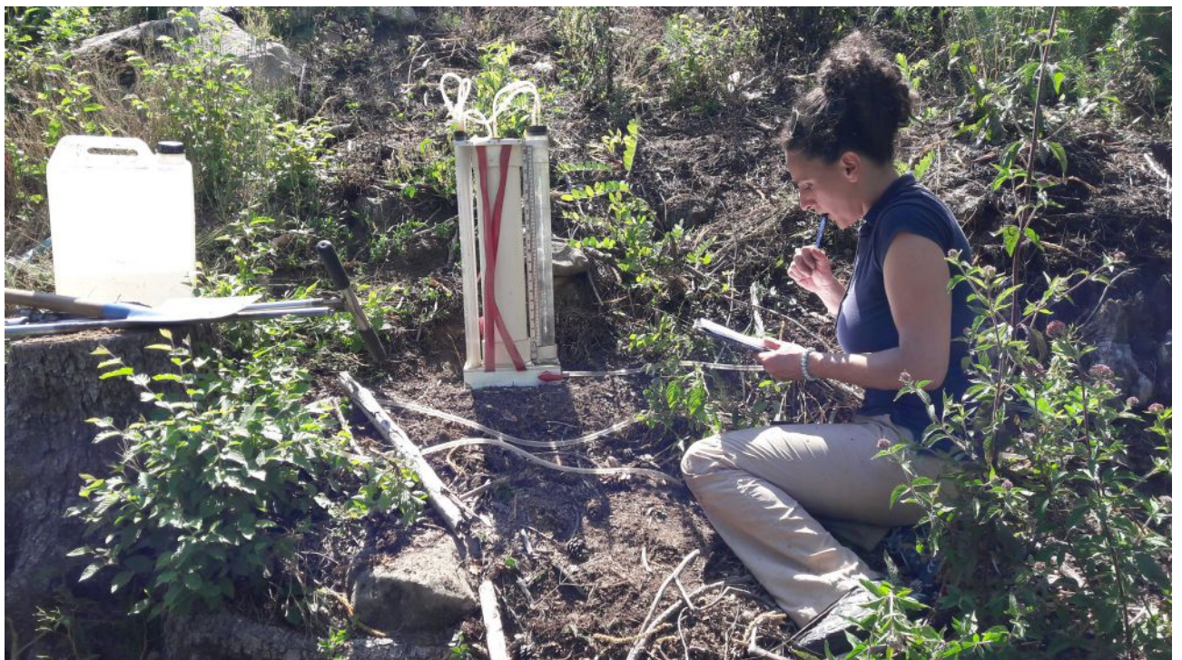
Figura 21 – Prove di permeabilità satura in situ tramite Amoozmeter
